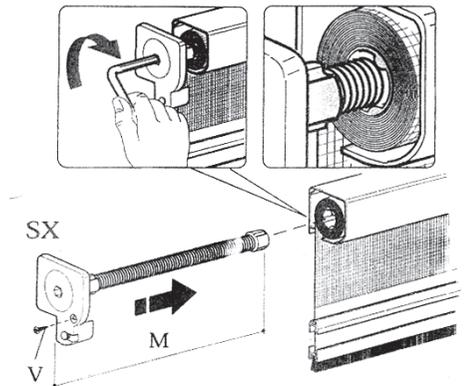
10. Caricare la molla con gli stessi giri di precarica trovati al momento dello smontaggio. **ATTENZIONE:** tenere ben saldo il tappo e il cassonetto durante l'operazione di ricarica. Terminata la procedura, reinserire il tappo nel cassonetto e fissarlo con la vite. L'operazione è possibile anche senza l'ausilio della chiave a brugola (da 6 mm) che si vede nell'immagine.
