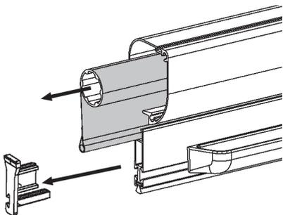
5. Srotolare tutta la rete dal tubo. Tagliare/sfilare la rete, facendo attenzione al senso di rotazione, in modo da riposizionare il nuovo telo rete in maniera corretta.
