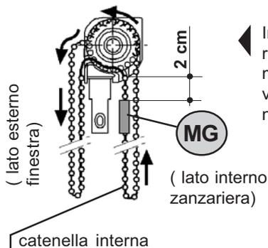
◀ Inserire il tappo DX a zanzariera avvolta, in modo che la maglia-giunzione (MG) si trovi in alto sulla catenella interna. Vedi fig.a lato.
