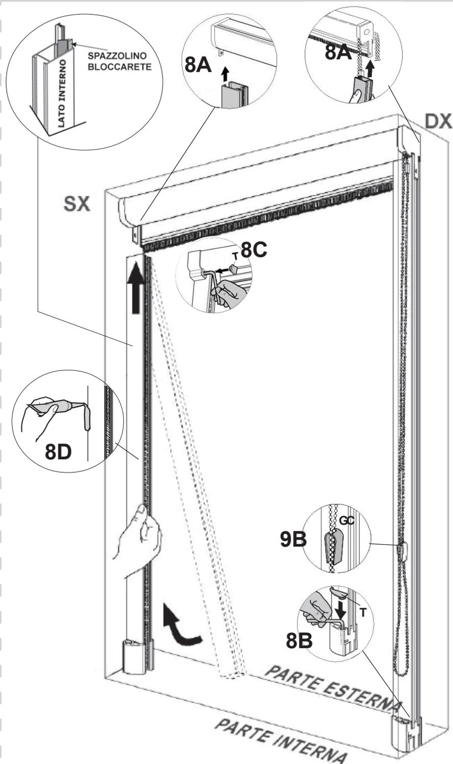
**NOTA:** la catena comanda direttamente il movimento. La zanzariera deve rimanere ferma in qualsiasi posizione se non viene azionata la catena. Se la zanzariera non rimane in posizione, può essere necessario regolare la forza frenante.
