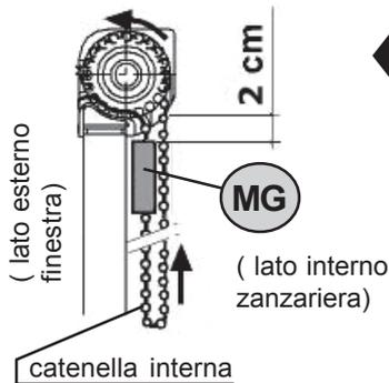
◀ Inserire il tappo DX a zanzariera avvolta, in modo che la maglia-giunzione (MG) si trovi in alto sulla catenella interna. Vedi fig.a lato.
