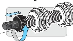
Se l'azionamento è molto duro e contrastato, **SVITARE** per diminuire la forza frenante.
